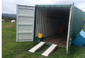
Sliskjur úr áli, fyrir lyftara og brettatjakka. Fyrir lyftara: L 100 cm x B 42 cm, par. Burðargeta á par: 7.200 kg. Fyrir brettatjakka: L 100 cm x B 70 cm. 1 stk. Burðargeta: 2.000 kg. Hákonarson ehf. S. 892-4163, netfang: hak@hak.is www.hak.is
