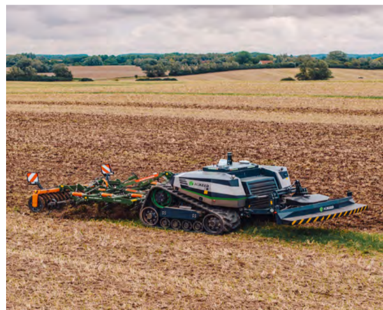
Ein af dráttarvélum ársins er AgXeed 5.115T2. Þetta er dísilknúinn sjálfkeyrandi beltatraktor sem er þegar kominn í notkun hjá bændum. Mynd / AgXeed
