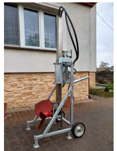
Glussadrifnar gólfhræsur. Vinnudýpt-1,9 m. Stærð á skrófu 48 cm. Rotor 12 kW. Glussaflæði 75 L/mín. 20 m af glussaslöngum fylgja. Mesta hæð frá gólfi 2 m. Burðarvirki, Heitgalv./SS stál. Hákonarson ehf. S. 892-4163. Netfang: hak@hak.is
