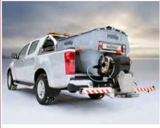
Hilltip Icestriker 380-550L Salt og sanddreifarari í tveim stærðum, fyrir minni pallbíla. Rafdrifinn 12V.
