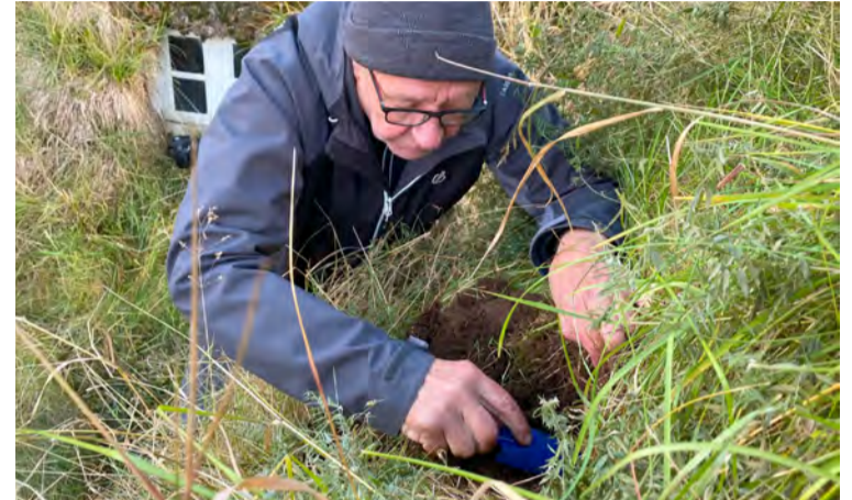
Björn kemur raka- og hitamæli fyrir í torfbakinu yfir dúnhúsinu í Laufási.
