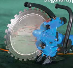
Tyrolit Ringsaw TR40 Steinsög - rafknúin Sögunardýpt 30cm
