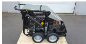
Stór og öflug háþrýstidæla fyrir verktaða til sölu. Dælan er ný og ónotuð, FDX Xtreme XL, www.comet-spa.com. Dælan er 16 L / min og max þrýstingur er 520 Bar. Vél - 26 hestöfl, Kohler, dísel, KDW 1003. Vélin er vatnskæld og með rafstarti. Hákonarson ehf. S. 892-4163. Netfang: hak@hak.is
