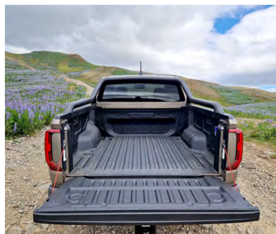
Amarok er vinnuteki með stórum palli. Á milli hjólaskálanna er nægt rými fyrir EURO-bretti á þverveginn.
