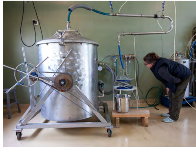
Gufan er leidd inn um botninn á þessum gamla mjólkurtanki. Á föt sinni í gegnum plönturnar losar vatnsgufan um ilmkjarnaolíu.
