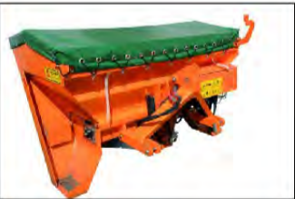
Salt- og sanddreifari HZS-10, 1 m 3 , glussadrifin, með klumpabrytót og tjakk
