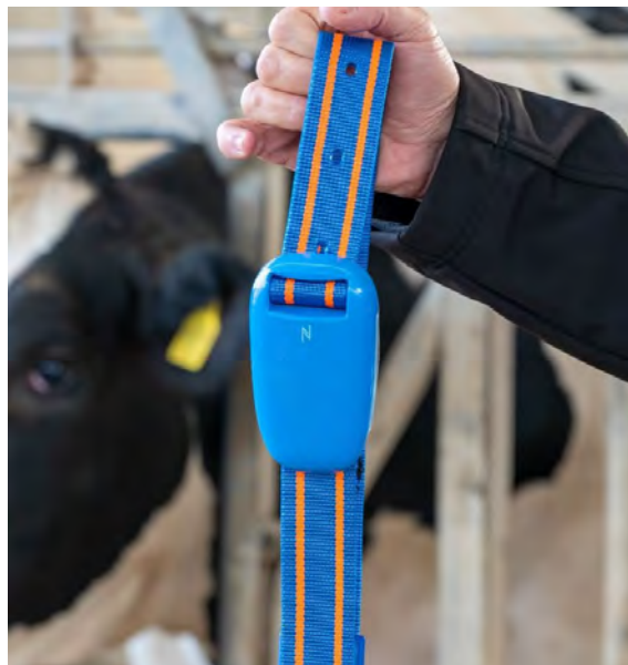
Mynd 1. Mörg fyrirtæki bjóða núorðið upp á einfalda tölvumæla, sem festir eru við hálsól kúnna eða eru hluti af eyrnamerkjum þeirra, sem „fylgjast“ með át-atferli kúa.
