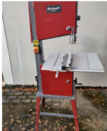
Bandsög - Einhell RT-SB 305 U (lítið notuð) Power 750W. Tro 300 mm. Sawband 2240x17 mm. Saw band speet 370 m/mín-800 m/mín (2 hraðar). Max cutting height 45° 90 mm. Max cutting height 90° 170 mm. Working table 520x400 mm. Table tilttable 0°-45° Verðhugmynd kr. 130.000. Tilboð og upplýsingar - arni0535@gmail.com.
