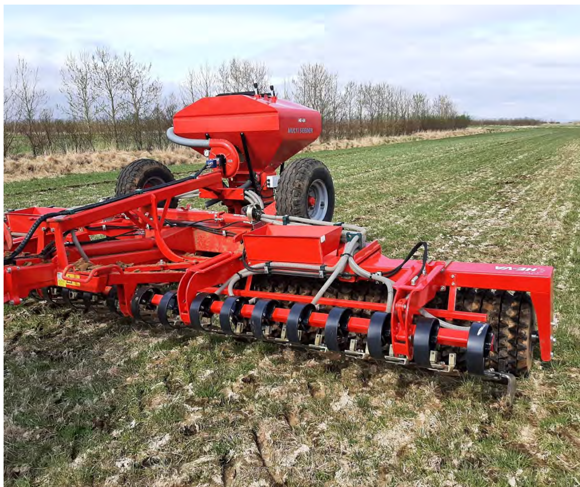
Yfirsáning með gjarðavalta á Hvanneyri, maí 2023.
