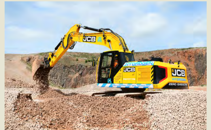
Í júlí kynnti JCB frumgerð af vetnisknúnni 20 tonna 220X beltagröfu, sem JCB fullyrðir að sé fyrsta vetnisknúna beltagrafan í heiminum.
