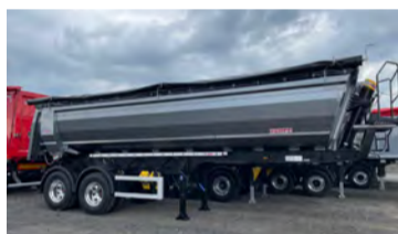
Nýr Kempf 2ja öxla malarvagn. Sérsmíðaður fyrir 3 ja öxla dráttarbíla. Hardox 450 - 8 mm botn og 5 mm hliðar. Alcoa Durabright felgur, Skúffa og grind heitsprautuzinkað, (tvöföld grind) 6 prepa sturtutjakkur, sem gefur ca:53 gr. halla, seglyfirbreiðsla. Th. Adolfsson ehf. S. 898 3612 - thadolf@gmail.com
