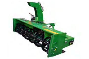
Vetrarvörur í úrvali, hér er 210 cm breiður snjóblásari frá Harðskafa sem hæfir litlum og miðlungs traktorum. Nýtt blað á www.hardskafi.is - sala@hardskafi.is - S. 555-6520.
