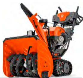
Snjóblásari ST424T 8,6 HP, vinnslubreidd 61cm, hiti í handföngum, tveggja þrepa kerfi, framljós, belti, rafstart.
