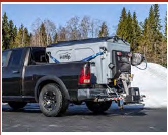
Hilltip Icestriker 900-1600L Salt og sanddreifari í tveim stærðum fyrir stóra pallbíl og minni vörubíla. Rafdrifinn 12V.
