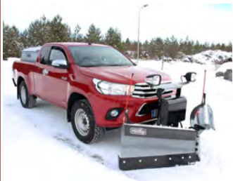
Hilltip Snowstriker VP Fjölplogur fyrir pallbíl, minni vörubíla og jeppa. Fáanlegur í 185-240 cm breidd.
